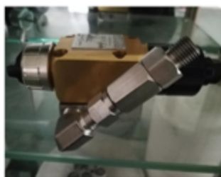
枪前过滤安装
